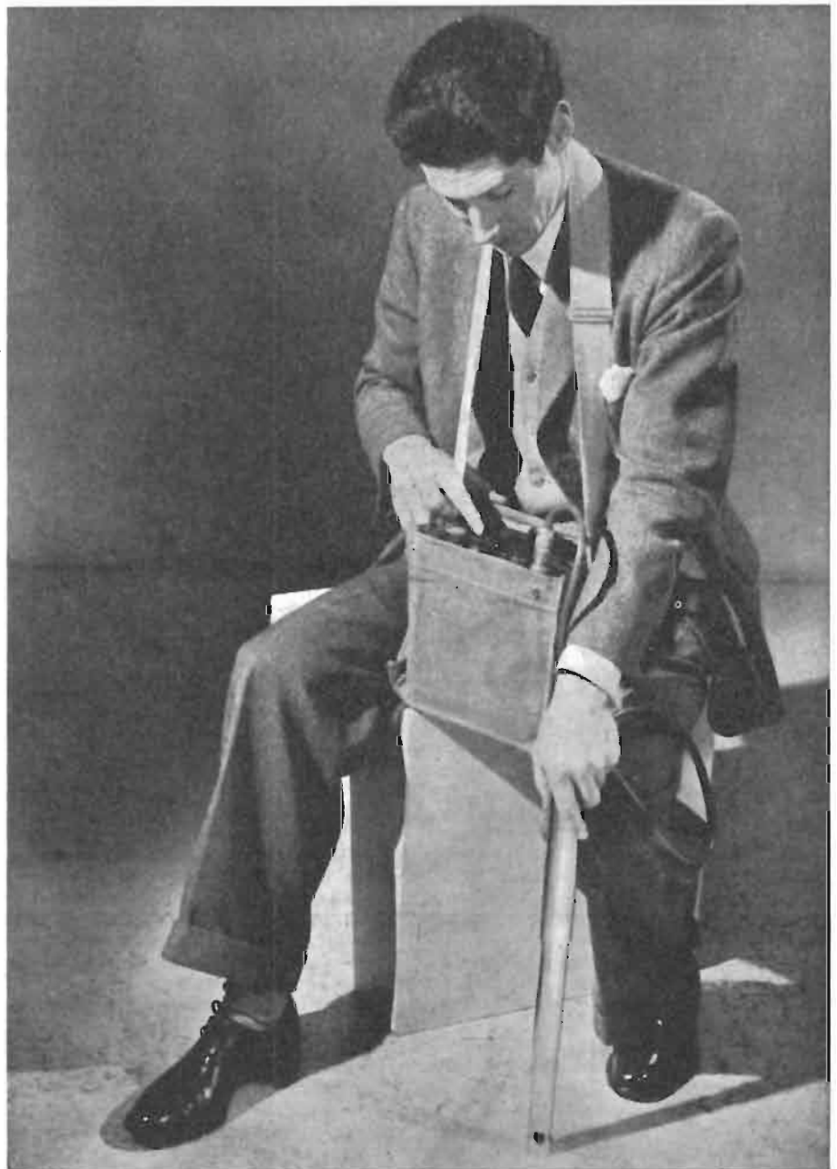
Un avvisatore di contaminazione radioattiva, fabbricato dalla Isotope Development Ltd. di Londra, in funzione. Lo strumento, assai semplice, è in grado di misurare la quantità di elementi radioattivi presenti nei liquidi.
